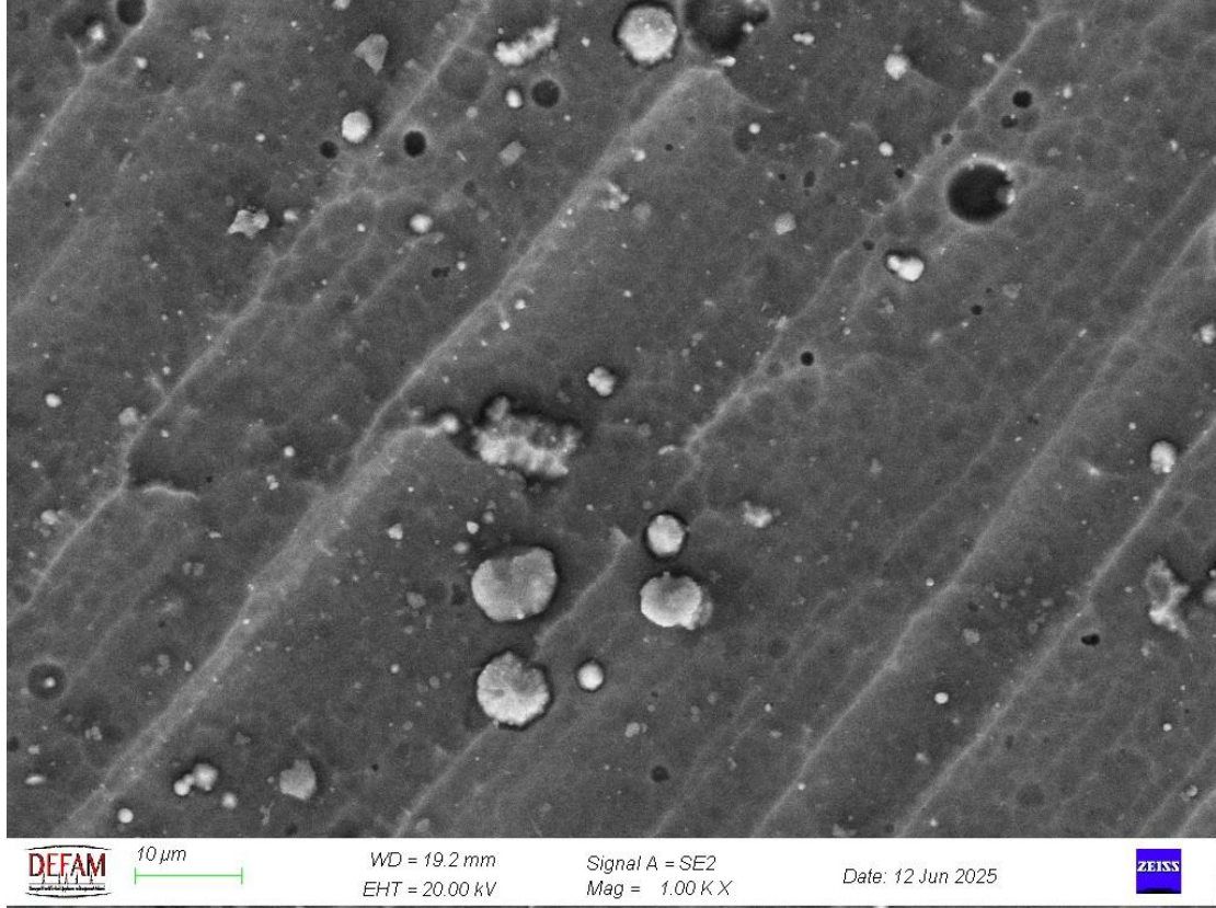
Şekil 10.b) TiN Kaplamalı Numunenin SEM Görüntüsü (1000X)
