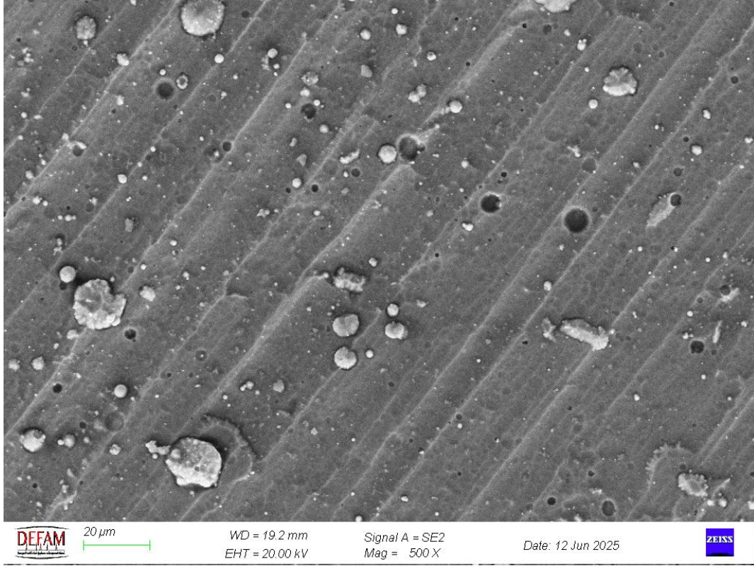
Şekil 10.a) TiN Kaplamalı Numunenin SEM Görüntüsü (500X)
